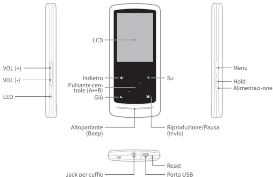
\* Se i pulsanti non funzionano o lo schermo non risponde al tocco, premere il pulsante [Reset] nella parte inferiore del dispositivo. Si noti che il pulsante Reset scollega semplicemente l'alimentazione senza danneggiare il prodotto e senza eliminare alcun file dal dispositivo.
