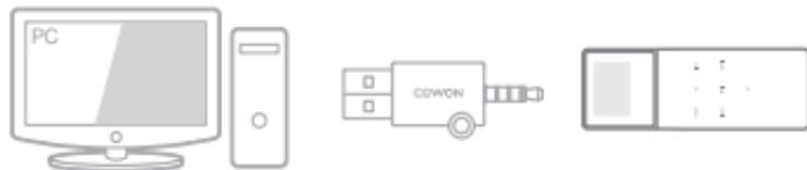
Подключайте iAUDIO E3 к стандартному порту USB компьютера с помощью переходника Simple USB, поставляемого в комплекте.
