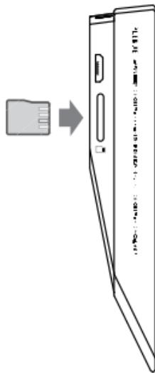
1. 依圖所示,將 microSD 記憶卡正確地放入 microSD 卡槽。輕輕地按下卡片,即可插入。
