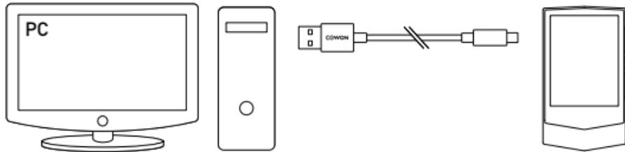
1. Micro USB 繼線能連接電腦和 Micro USB 連接埠。
