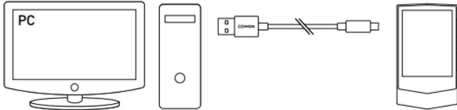
1. 使用Micro USB电缆连接PC和Micro USB插座。
