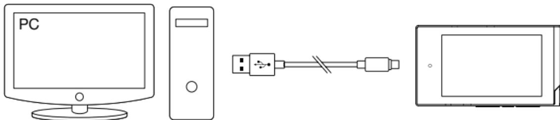
1. Mit dem Micro USB-Kabel wird eine Verbindung zwischen PC und Micro USB-Anschluss hergestellt.
