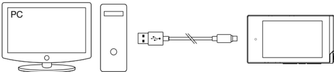
1. 使用Micro USB电缆连接PC和Micro USB插座。
