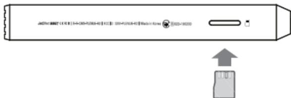
1. Inserire correttamente la scheda microSD nello slot per la scheda microSD come illustrato nella figura. Premere delicatamente la scheda per inserirla.
