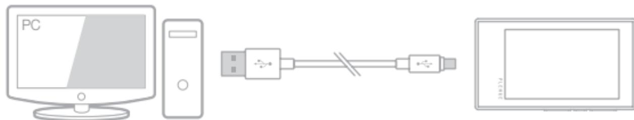
1. Mit dem Micro USB-Kabel wird eine Verbindung zwischen PC und Micro USB-Anschluss hergestellt.
