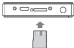
1. Die microSD-Karte, wie in der Abbildung dargestellt, richtig in den microSD-Kartenschlitz einlegen. Die Karte zum Einsetzen leicht drücken.
