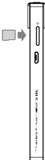
1. Die microSD-Karte, wie in der Abbildung dargestellt, richtig in den microSD-Kartenschlitz einlegen. Die Karte zum Einsetzen leicht drücken.
