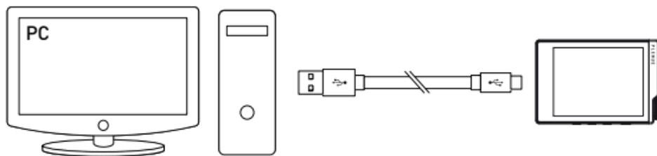
1. Mit dem USB-Kabel wird eine Verbindung zwischen PC und USB-Anschluss hergestellt.
