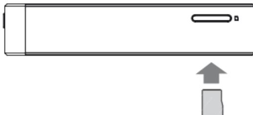
1. Die microSD-Karte, wie in der Abbildung dargestellt, richtig in den microSD-Kartenschlitz einlegen. Die Karte zum Einsetzen leicht drücken.
