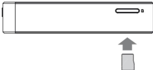
1. 依圖所示, 將 microSD 記憶卡正確地放入 microSD 卡槽。輕輕地按下卡片, 即可插入。
