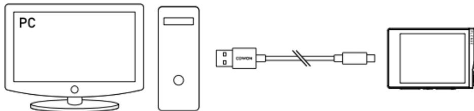
1. El cable micro USB se conecta a la PC y al puerto micro USB.
