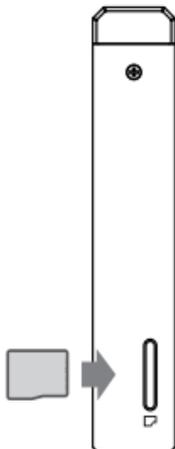
1. Coloque adecuadamente la tarjeta microSD en la ranura para tarjeta microSD tal como se muestra en la imagen. Presione suavemente la tarjeta para insertarla.
