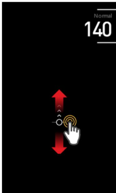
转动音量转轮或在音量调整界面中通过上下滑动触摸屏即可调音140档。增加一个级别，音量则增加0.5dB。
