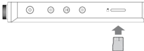
1. 如左图所示, 将microSD卡朝正确的方向插入设备的microSD卡槽。
