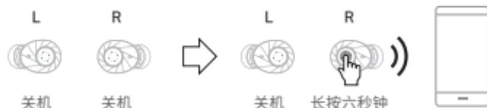
单耳模式：CR5的左右两个耳机可各自单独使用。(单声)
