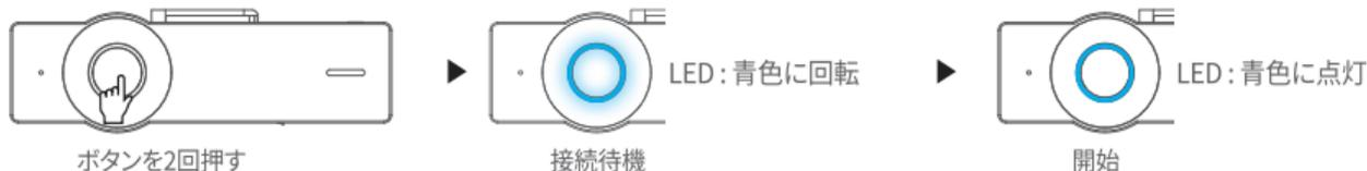
側面のボタンを2回押すと、Wi-Fi開始の音声案内とともに、動作ステータスLEDが青色に回転し、Wi-Fiが接続されると青色に点灯します。Wi-Fiの利用後、スマートマネージャーを終了するか、ボタンを再び2回押すと、Wi-Fiの接続を終了します。
