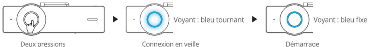
Si vous appuyez deux fois sur le bouton latéral, le voyant bleu tourne et un message vocal vous indique l'activation de la connexion Wi-Fi. Une fois la connexion Wi-Fi établie, le voyant reste fixe. La connexion Wi-Fi est désactivée à l'arrêt de Smart Manager ou lorsque vous appuyez deux fois sur le bouton.
