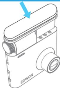
両面テープの剥離紙をはがした面を据置台に貼り付けます。
